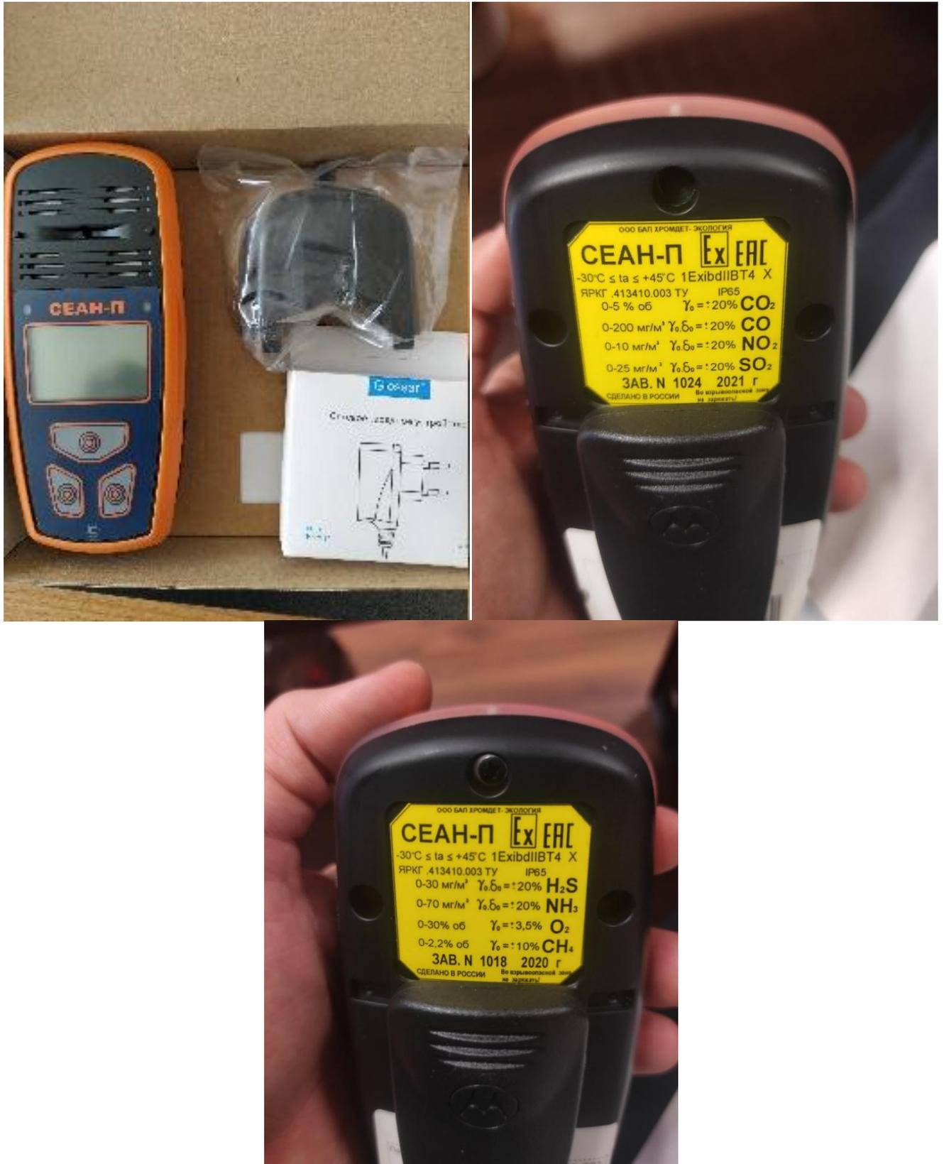
Рисунок 4.3 – Приборы для измерения концентрации газов
