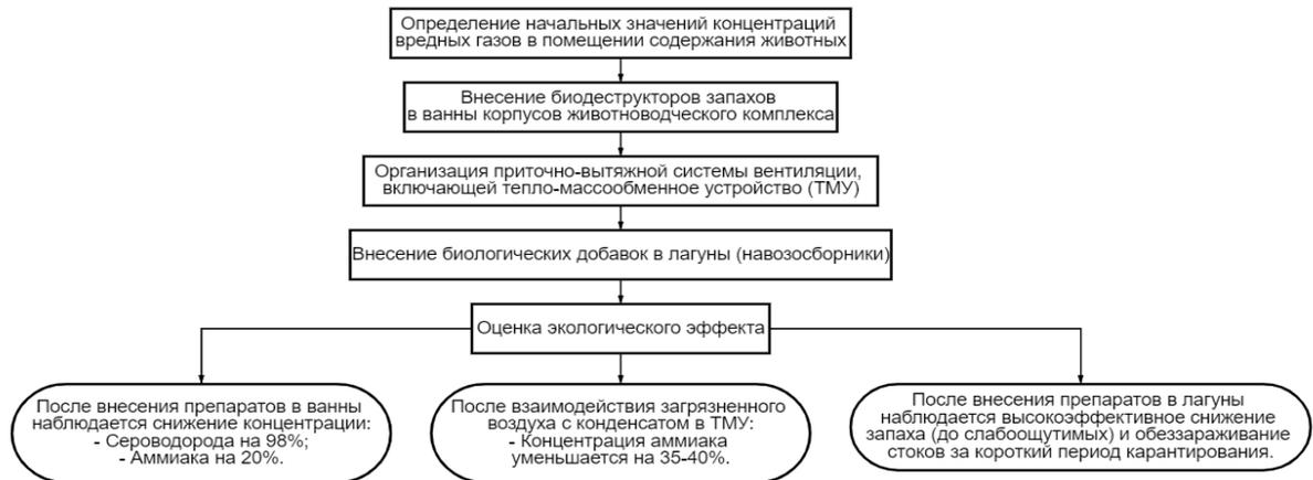
Рисунок 5.6 – Алгоритм комплексной системы создания параметров микроклимата в животноводческих помещениях с элементами охраны воздушного бассейна
