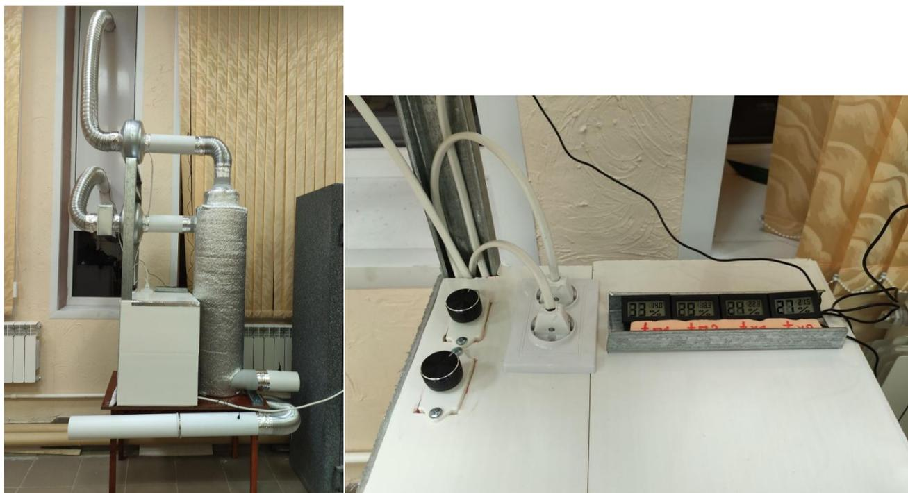
Рисунок 3.9 – Фото экспериментального стенда для исследования работы теплообменного устройства
