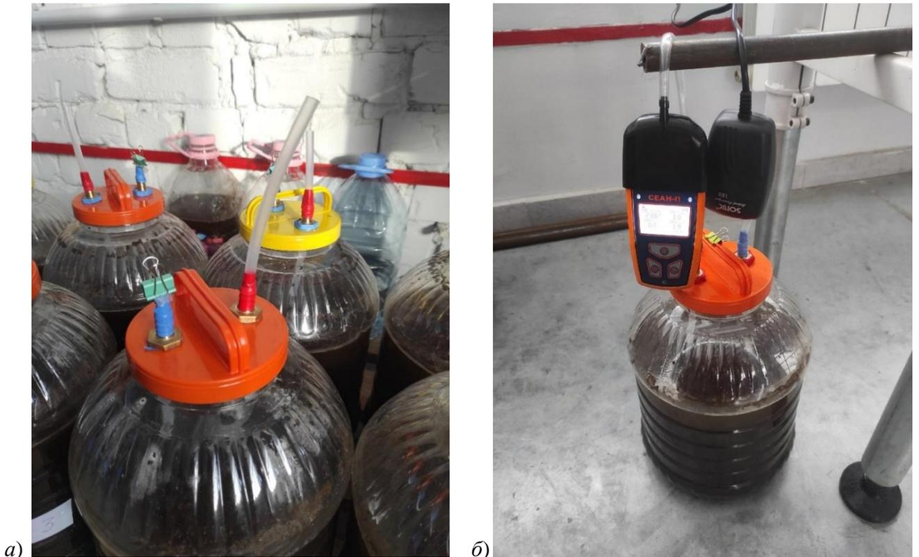
Рисунок 4.2 – Емкости с навозостоками (а) и варианты присоединения оборудования для замеров концентрации газов (б)
